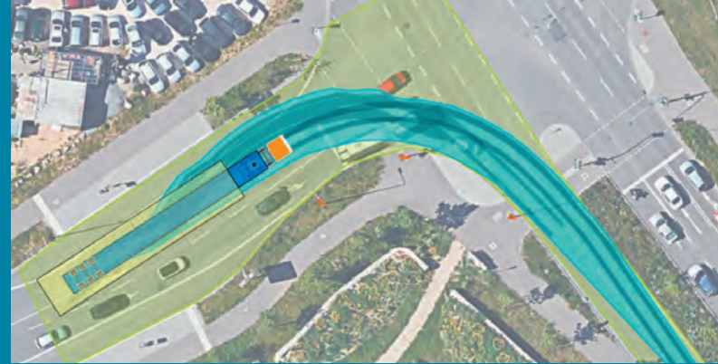
TruckTrix® – digitale Visualisierung einer Engstelle
