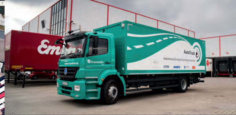
AutoTruck – e-Lkw mit Steer-by-Wire und Drive-by-Wire
