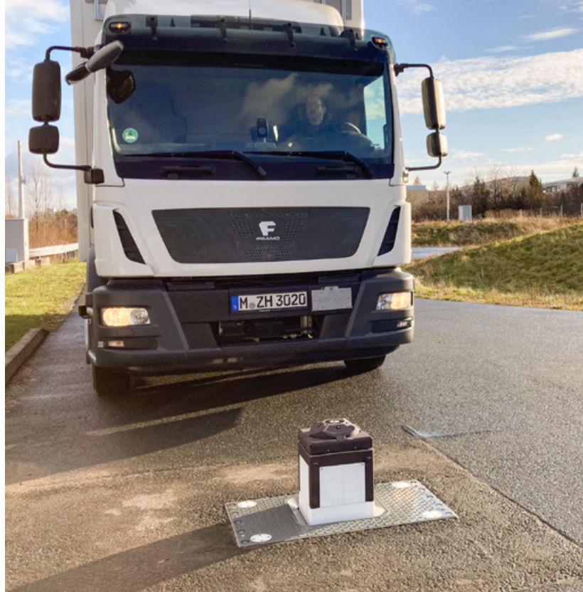
Prototyp des Unterbodenladesystems auf dem Testoval des Fraunhofer IVI in Dresden.
