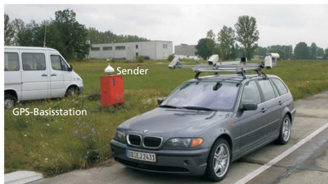
Abb. 2: Pkw-Versuchsfahrzeug mit GPS und NIR Kameras.
