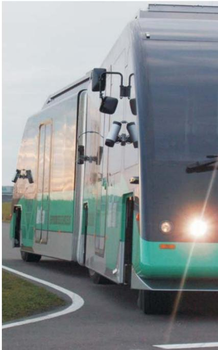
Abb. 1: Versuchsfahrzeug AutoTram® mit Front- und Seitenkameras.
