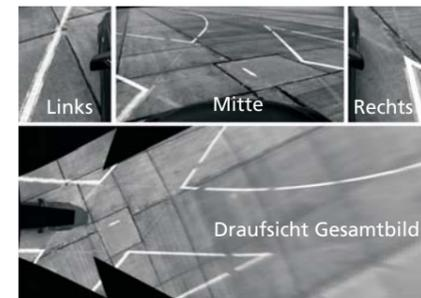
Abb. 4: Ermittlung des Gesamtbilds zur Fahrspurerkennung.
