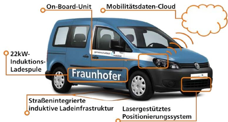
Überblick der Einzeltechnologien die im Projekt »Gemeinschaftlich-e Mobilität: Fahrzeuge, Daten und Infrastruktur (GeMO)« gemeinsam von sechs Fraunhofer-Instituten entwickelt und im Prototyp eines Fahrzeugs verbaut werden. ©Fraunhofer IAO 2013
