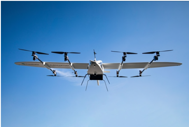
Abb. 1 Der ALBACOPTER® – eine Symbiose aus Multicopter und Gleiter
